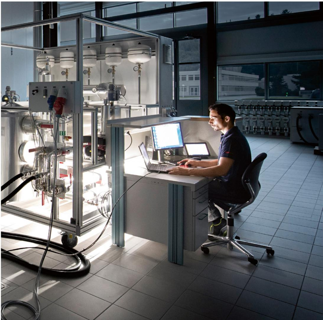
*Prüfstand für Wärmepumpen
